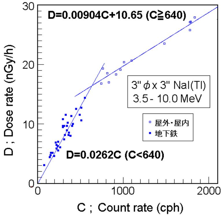
ここでは簡便法により 3"  $\phi$  x 3" NaI(Tl) の 3.5~10 MeV の 1 時間当たりの計数率 (cph) と宇宙線線量率を関連づけた。将来は電離箱や TLD, ガラス線量計などの線量測定器により大型建造物内や地下深い地点まで同時測定して、より精度の高い換算係数を求めるのが望ましい。
